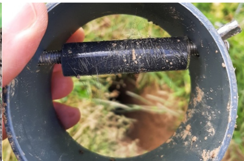
Een haarval in een van de pijpen van een hamsterburcht (links) en succesvolle verzameling van haren op het 'rolletje' met dubbelzijdig plakband (rechts).
